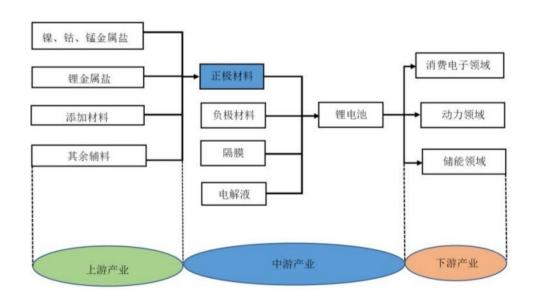
锂电池正极材料主要分为三元材料、钴酸锂、锰酸锂及磷酸铁锂四种类型,四种材料因各自的特性差异应用于不同市场。经过十多年的发展,我国已经成为全球锂电池正极材料主要的制造国之一,其中,我国在钴酸锂及锰酸锂材料方面目前已成为世界最大出口国,磷酸铁锂及三元正极材料方面成为世界最大生产及使用国。由于受下游不同应用市场的需求所驱动,我国锂电池正极材料经历了三个主要发展阶段:
